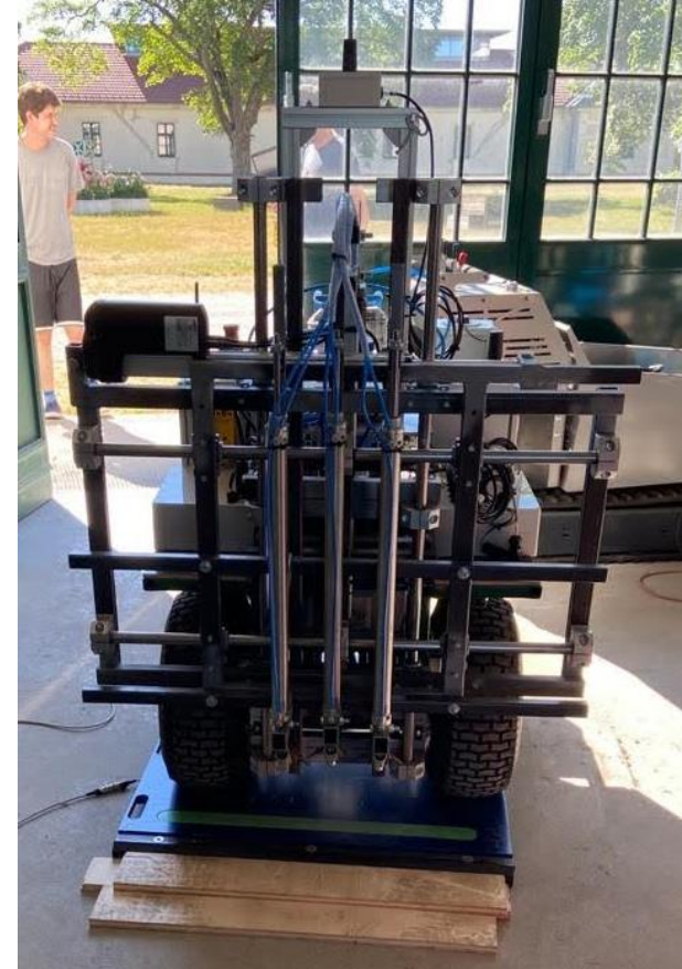
Abb. 10: Blick auf den Verschubrahmen mit Hackelementen
