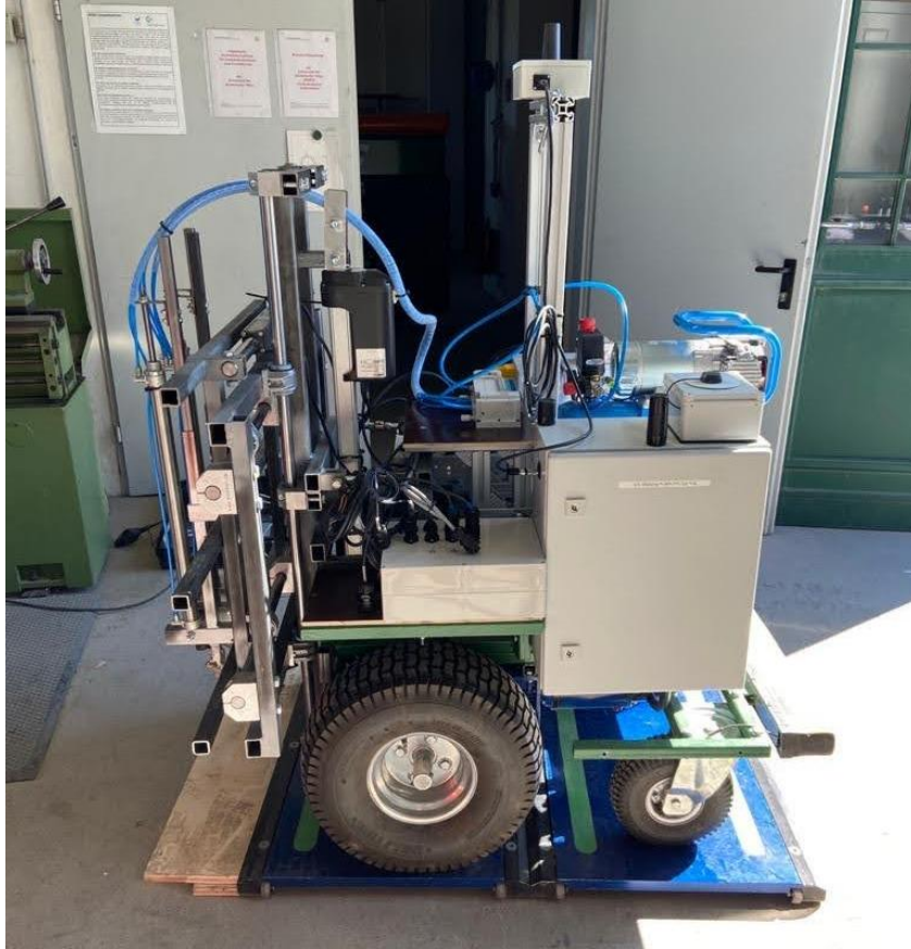
Abb. 9: Seitenansicht Roboter mit Hacke
